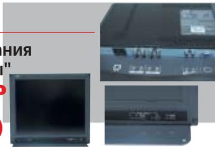
Монитор является двухобъемной моноблочной конструкцией с металлическим корпусом, окрашенным в матовый темно-серый цвет. В комплект входит плоская металлическая подставка, крепящаяся к монитору двумя винтами. Степеней свобо-
